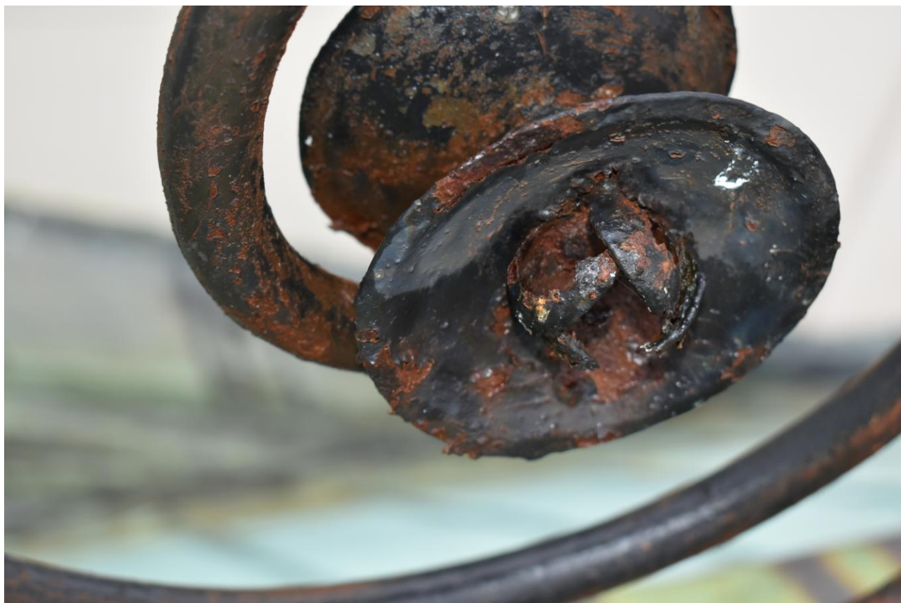
Obr. č. 16 + 17: Detailní pohled na místa poškozená korozním procesem – původní stav. Prvky vyrobené ze slabších plechů jsou vlivem korozního úbytku bez kovového jádra.
